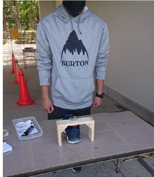
② 測定器の下にスパイクおよびシューズを置きます。(踵にピンがあるものは高さ1cmのスペーサーを置いてから計測します。)
